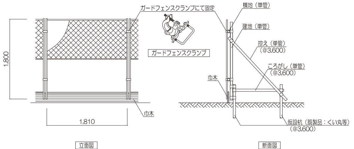
**設置例** フェンスバリケードをH鋼で施工した場合
