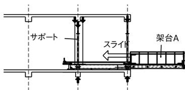
荷台AからBにスライドし、建物内部で自由に荷さばき作業ができます。
