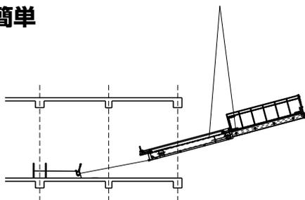
四点サポート式で簡単に設置ができ、更にも上層階への盛替えも簡単に行えます。
