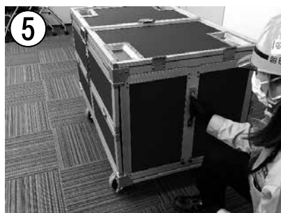
⑤ 妻面パネルが確実に固定されたことを確認 ※反対側も同様に組立てる
