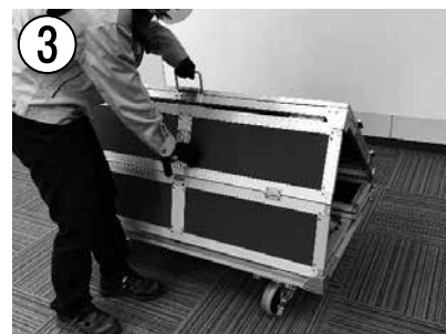
③ 桁側固定フックをロックする ※固定フックを下部金具へ落とし込む ※反対側も同様に組立てる
