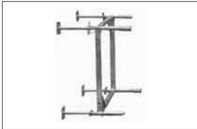
① ベース&ヘッドフレームにベーススピンドルを差し込みセーフティストラップで固定します。
