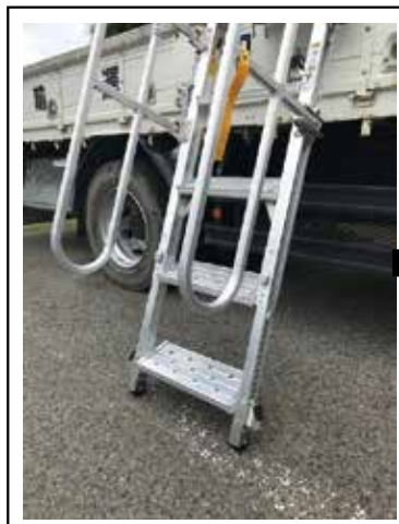
① ステップ幅：150mm ② 348mm（脚伸縮）20mmピッチ
