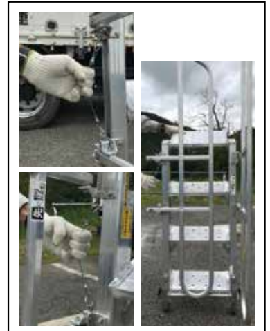
手摺の操作はワイヤーで折畳みがワンタッチ
