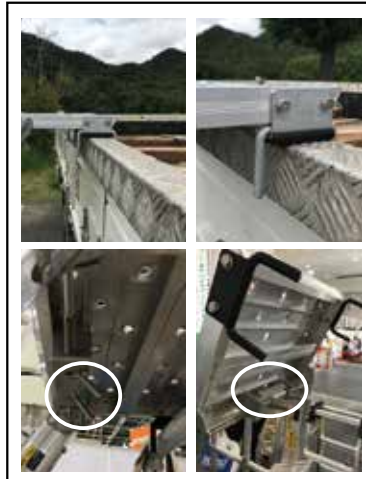
天板はロックピン機構で設置がワンタッチ
