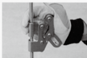
② 90° 反時計回りに起し、握った手を放す。 ⚠ 上下方向を間違えないで下さい。
