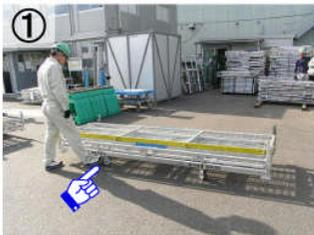
① 車輪を**ロック**した状態で作業して下さい。
