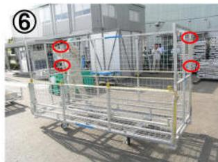
⑥ 桁面枠上段を立上げ**ロック**します。
