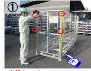
① 車輪を**ロック**し、妻面上部4ヶ所のフックをはずす。(反対側も同様)
